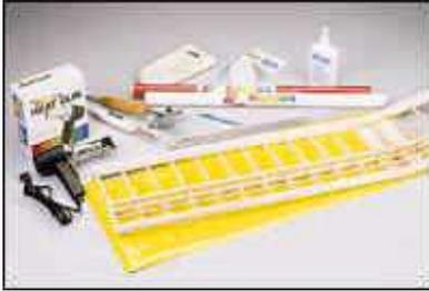
1.- Las únicas herramientas necesarias para entelar con Monokote son: una plancha para Monokote, una regla metálica, una cuchilla afilada y un rotulador fino.
