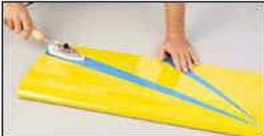
**11.-** Puede diseñar sus propios filetes, recortarlos en Monokote y pegarlos a su vez sobre superficies enteladas con Monokote. Use una temperatura baja, entre 110 y 120 °C para prevenir que las burbujas de aire queden atrapadas entre las capas de Monokote. Trabaje lentamente desde el centro de la tira hacia los bordes para quitar las burbujas.
