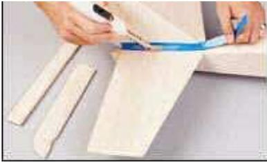
entele con tiras de entre 15 a 20 mm las zonas de unión, como se muestran en la foto. Después entele estabilizador y timón. El estabilizador y el timón deben de ser entelados antes de instalar las bisagras. El fuselaje típico se entela en 4 partes y en este orden: inferior, laterales y superior, solapando cada pieza entre 3 y 6 mm.
